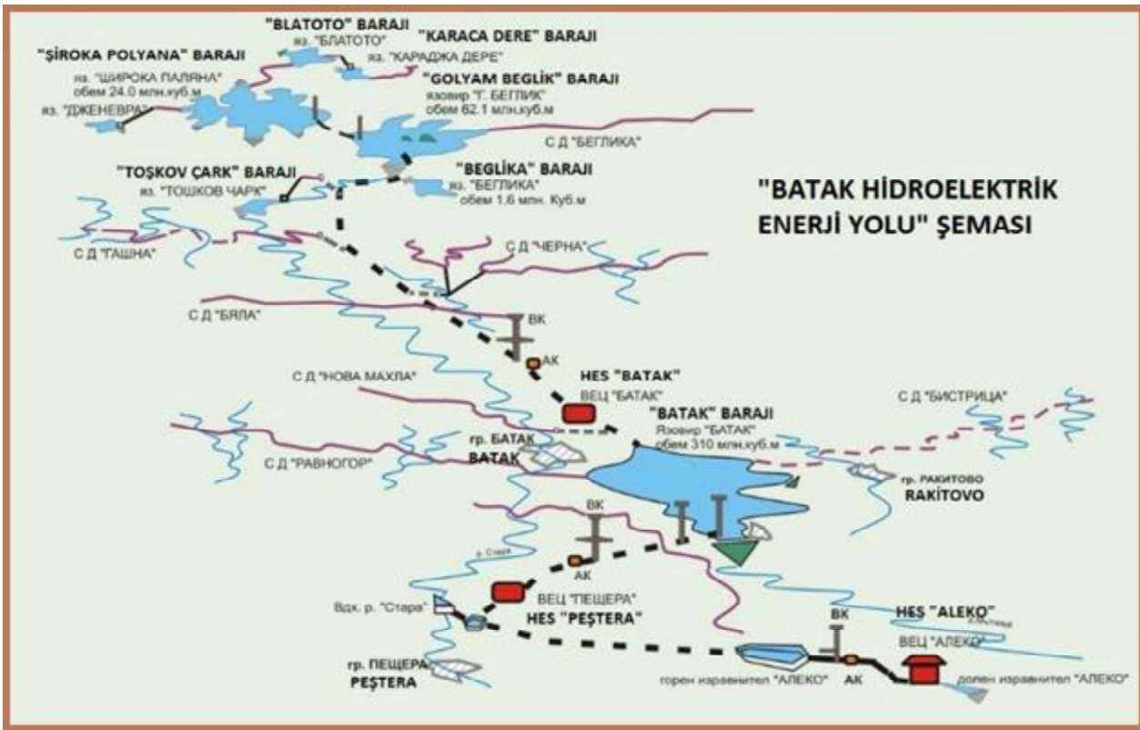
"Batak Hidroelektrik Enerji Yolu" Şeması.
